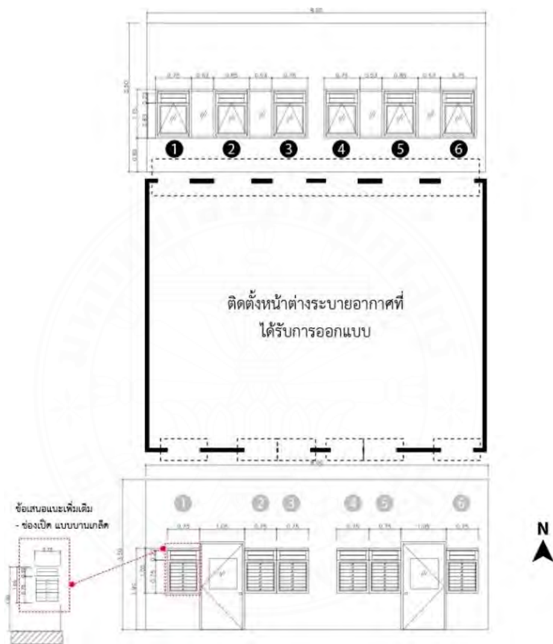
ภาพที่ 6.12 ห้องเรียนแบบมาตรฐาน สพฐ. หลังติดตั้งหน้าต่างระบายอากาศออกแบบโดยผู้วิจัย
